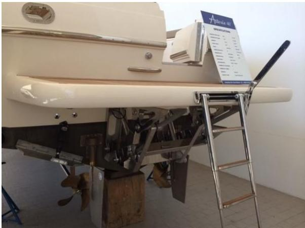
échelle de bain télescopique et plage de bain hydraulique
